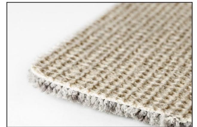
Abb. 13: Warenrückseite, Zweitrücken aus Gewebe
