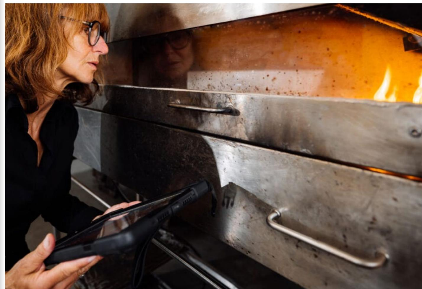
Fig. 65: observation du test de feu dans la chambre de test „Radiant Panel“; Source: TFI Aachen
